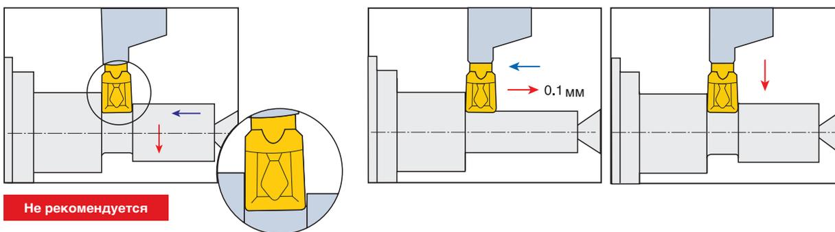
Токарный инструмент серии T-Clamp является многофункциональным, он позволяет выполнять последовательную обработку: обработка канавки с последующим точением. Однако переход от точения к обработке канавки требует соблюдения основного принципа работы с инструментом серии T-Clamp, который устраняет вероятность поломки пластины. Этот принцип заключается в устранении вспомогательного угла в плане, который образуется во время точения, но который недопустим при обработке канавки.
