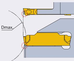
**Dmax (мм) для отрезки и нарезания канавок**
