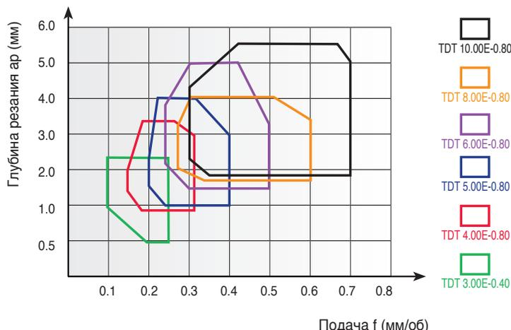
Для внутренней и торцовой обработки уменьшить скорость резания на 20-30%.
