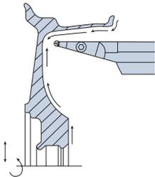
**TTER/L-15A** Обработка алюминиевых колес
