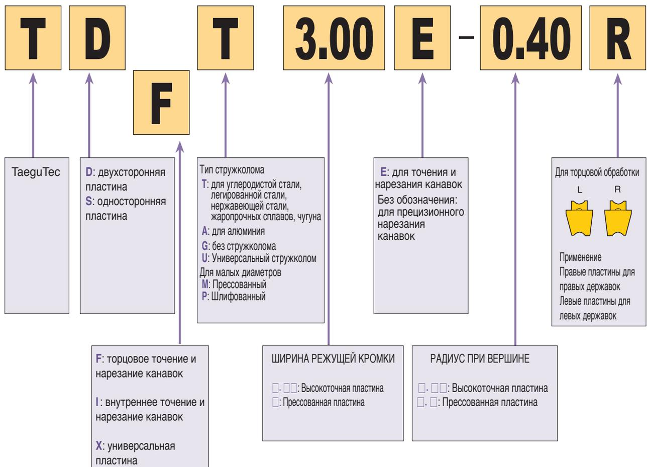
**TDC Двухсторонние пластины для отрезки и нарезания канавок со стружколомом "С"-типа**
