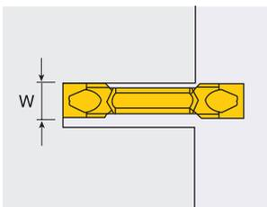
В зависимости от формы обрабатываемой канавки выбирайте по возможности самые широкие пластины и инструмент.
