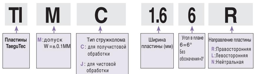
TIPV Точение, нарезание канавок и контурная обработка стружколомами V типа
