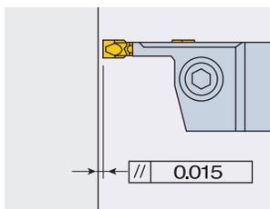
Проверить параллельность режущей кромки относительно обработанной поверхности. Правильное положение пластины обеспечивает высокое качество поверхности при точении торца в обоих направлениях.
