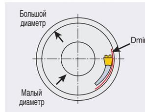
В зависимости от начального диаметра канавки выбирайте по возможности инструмент, с помощью которого можно обработать канавку как можно большего диаметра.
