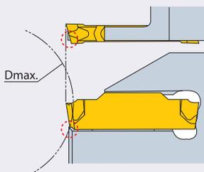
**Dmax (мм) для отрезки и нарезания канавок**
