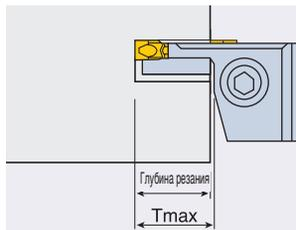
В зависимости от наибольшей глубины канавки выбирайте по возможности инструмент с наименьшим вылетом пластины.
