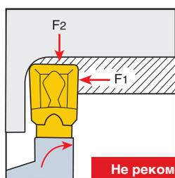
При обработке угла или фаски с радиусом большим, чем радиус при вершине режущей кромки, всегда требуется комбинация перемещений в двух направлениях. Проблемы, такие как поломка пластины, возникают только в том случае, если пластина имеет контакт с заготовкой по всем кромкам, так как поломка происходит из-за одновременного воздействия на пластину сил, которые имеют разное направление: F1 и F2 – как показано на рисунке слева.
