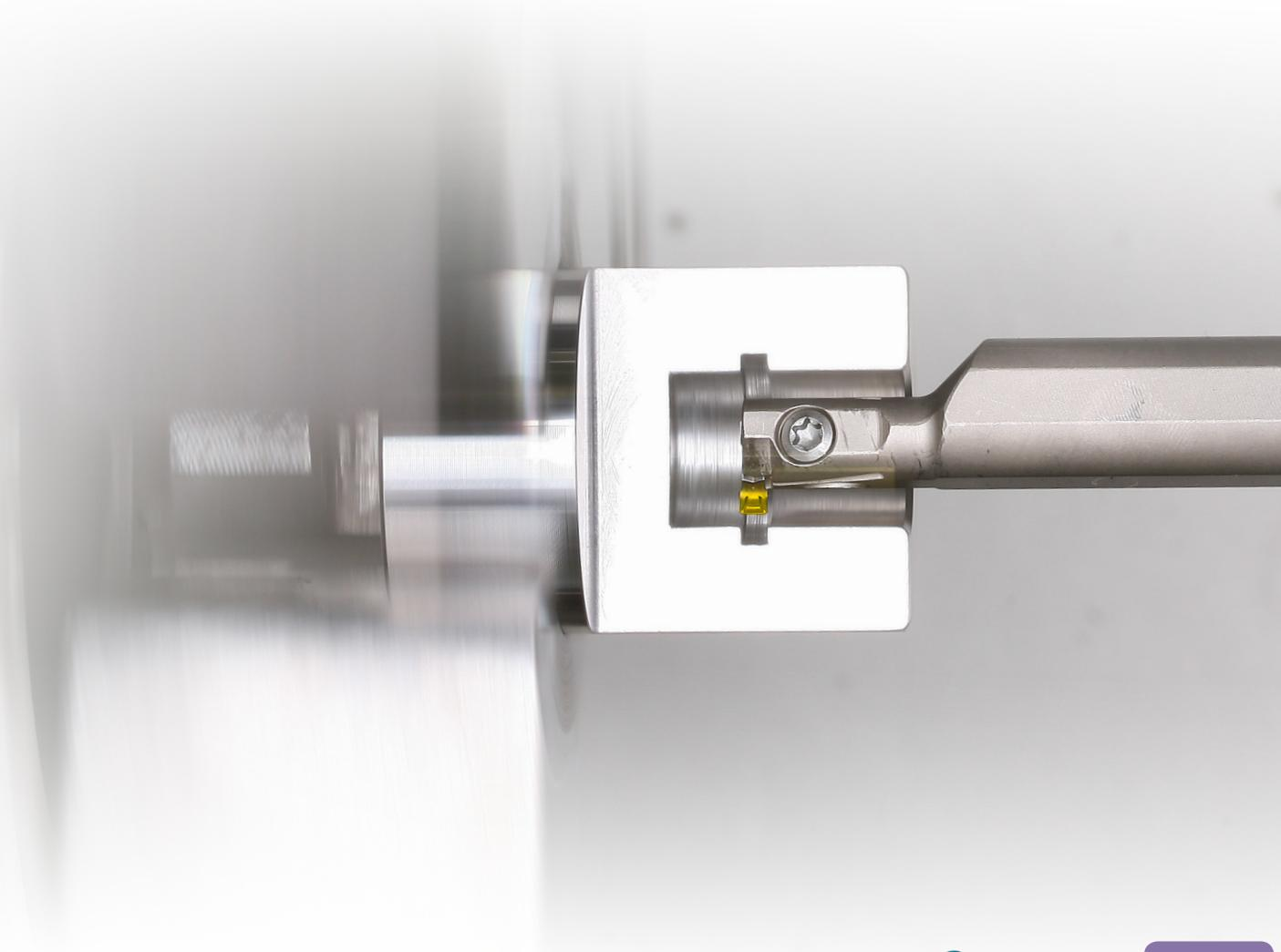
**TIMC** Отрезка и нарезание канавок стружколомами С типа
