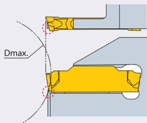
**Dmax (мм) для отрезки и нарезания канавок**
