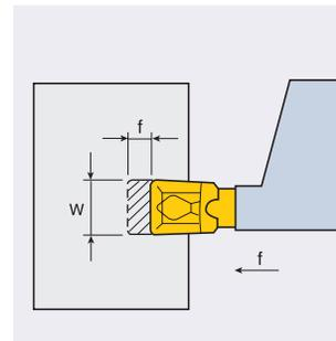
При наличии значения  $K_c$  может быть использовано специальное усилие резания ( $\text{H}/\text{мм}^2$ )
