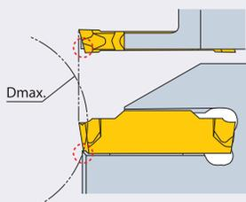
**Dmax (мм) для отрезки и нарезания канавок**
