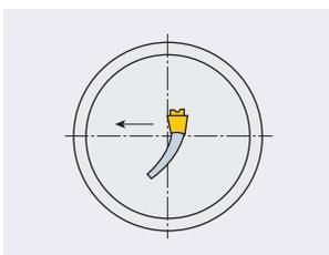
Проверить высоту режущей кромки у осевой линии, выполнить точение в лёгком режиме к центру и проверить наличие заусенцев.
