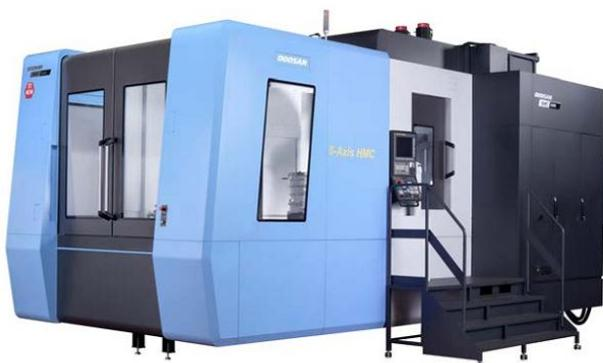
DHF 8000 - это 5-осевой горизонтальный обрабатывающий центр с двойной палетой (800мм), оборудованный шпиндельной головкой наклонного типа для поддержания всех обрабатываемых процессов - от черновой до чистовой обработки с одного установа.
