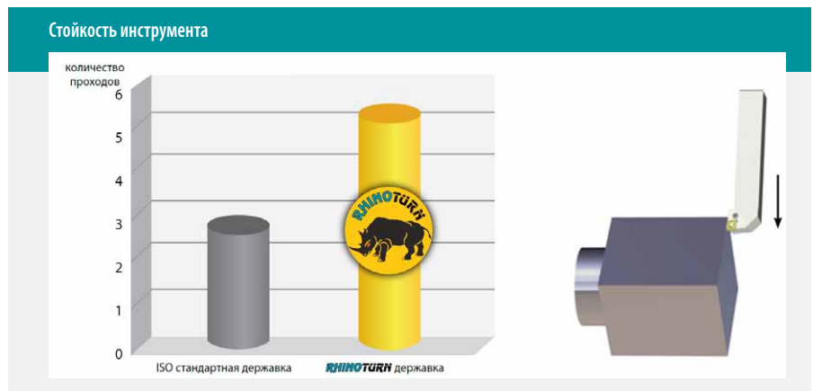
↑ Рис. 4. Сводная диаграмма стойкости инструмента и схема обработки при испытаниях
